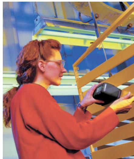
**Tragbares Farbmessgerät von X-Rite mit 0°/45° Messgeometrie und 3 Messblenden für unterschiedliche Anwendungen.**
