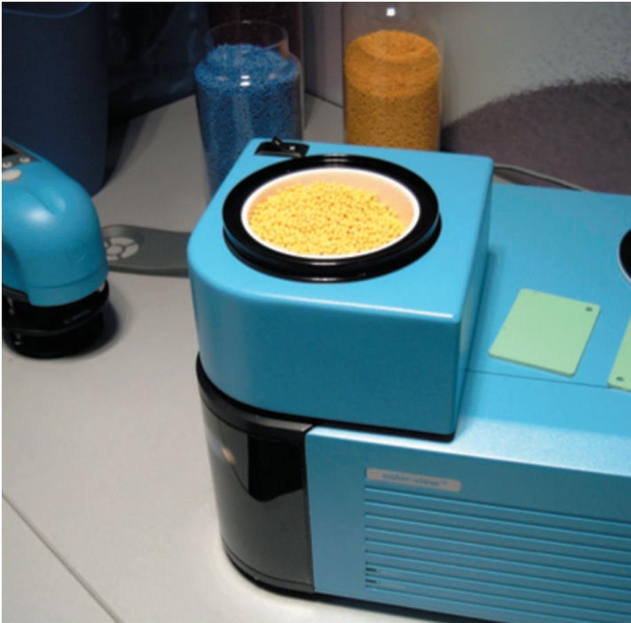
Gut durchdachte Anwendungstechnik und Messhilfe für die Farbbewertung von Granulaten in drehbarer Küvette von Byk Gardner.
