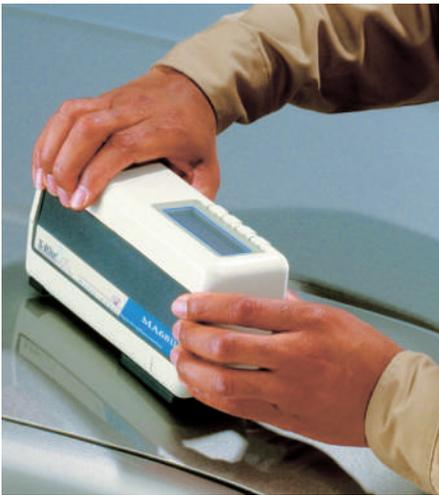
Mehrwinkelfarbmessgerät MA6811 von X-Rite mit 5 Messwinkeln überwiegend zur Farbmessung an Automobiloberflächen im Metall-Look.
