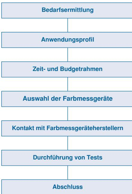
**Ablaufdiagramm für eine systematische Einführung von Farbmessgeräten.**
